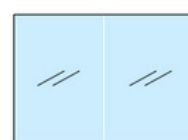
A-11 CRISTAL CONTINUO Estructura perimetral de aluminio extrusionado, perfilera de "U" con cristal continuo (sin aluminio entre paneles).
