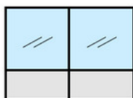
A-6 CRISTAL / MADERA Estructura interna oculta de aluminio extrusionado con panel de melamina bajo y panel de cristal.
